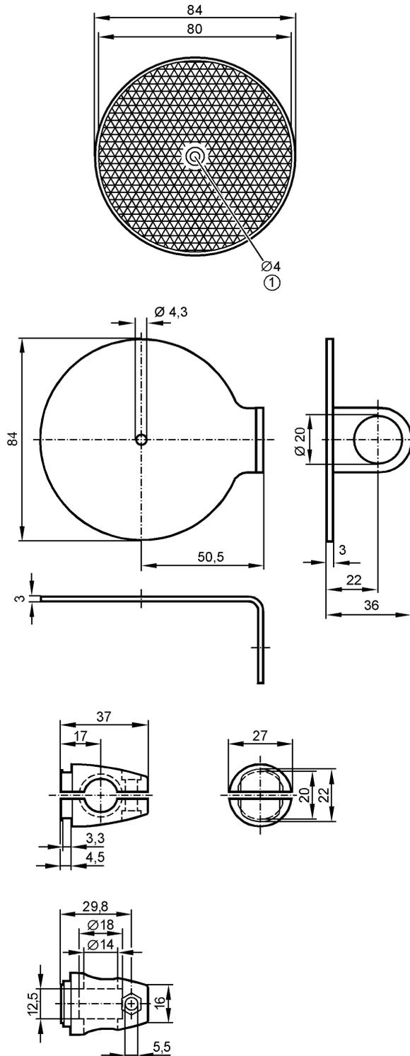
1: Ø Schraubenkopf bis 7,5 mm
