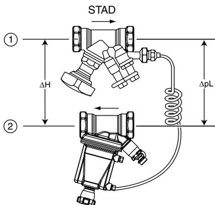
**Achtung!** Das STAP muss im Rücklauf in der angegebenen Flussrichtung eingebaut werden.
