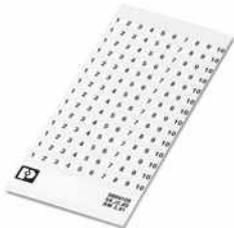
Kennzeichnungskarte, weiß, beschriftet, längs: fortlaufende Zahlen 1 ... 10, 11 ... 20 usw. bis 91 ... (99)100, Montageart: kleben, für Klemmenbreite: 3,81 mm, Schriftfeldgröße: 3,81 x 2,8 mm
