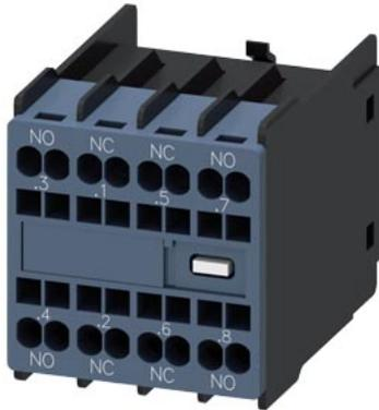
Hilfsschalter, frontseitig, 2 S + 2 Ö, 11 U, .3/4, .1/2, .5/6, .7/8, Strombahn: 1 S, 1 Ö, 1 Ö (nacheilend), 1 S (voreilend), Federzuganschluss, für Schütze 3RT2 und Hilfsschütze 3RH2
