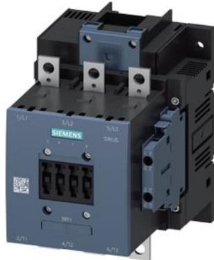
Leistungsschütz, AC-3 185 A, 90 kW / 400 V AC (50-60 Hz) / DC-Betätigung AC/DC 500-550 V Hilfskontakte 2 NO + 2 NC 3-polig, Baugröße S6 Schienenanschlüsse Antrieb: konventionell Schraubanschluss
