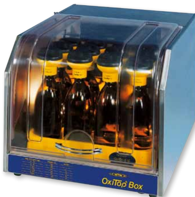
Anwendungsbeispiel: OxiTop® Box mit OxiTop® Control 12
