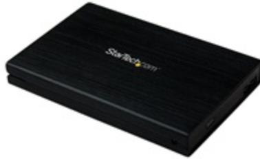
Le boîtier pour disque dur USB 3.0 avec UASP S2510BMU33 vous permet de connecter un disque dur 2,5 pouces ou un lecteur à état solide (disque SSD) SATA III via un port USB. Le boîtier fournit une performance optimale avec une connexion USB 3.0, mais il est également rétrocompatible avec les connexions hôtes USB 2.0/1.1.
