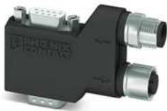
D-SUB-Stecker, 9-polig, Buchse, mit PG-D-SUB-Stift, Belegung: 2, 3, 5, 6, 7, 9; zwei M12-Kabelzuführungen (A-kodiert) unter 90°. Bussystem: CAN, CANopen. Abschlusswiderstand über separaten M12-Terminator.
