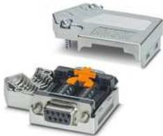
D-SUB-Stecker, 9-polige Buchse, Kabelzuführung unter 35°, Bussystem: CAN, CANopen<sup>®</sup>, SafetyBus-P bis 1 MBit/s, mit PG D-SUB-Buchse zum Anschluss eines Programmiergeräts, Abschlusswiderstand ü. Schiebeschalter zuschaltbar, Pinbelegung: 2, 3, 7, 9; Schraubklemmen
