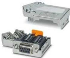
D-SUB-Stecker, 9-polige Buchse, zwei Kabelzuführungen unter 35° auf zwei Klemmreihen, Bussystem: CAN, CANopen, SafetyBus-P bis 1 MBit/s, Abschlusswiderstand über Schiebeschalter zuschaltbar, Pinbelegung: 2,3,7,9; Schraubanschlussklemmen
