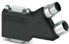
D-SUB-Stecker, 9-polig, Buchse, mit PG-D-SUB-Stift, Belegung: 2, 3, 5, 6, 7, 9; zwei M12-Kabelzuführungen (A-kodiert) unter 35°. Bussystem: CAN, CANopen. Abschlusswiderstand über separaten M12-Terminator.
