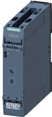
Zeitrelais, elektronisch rückfallverzögert ohne Steuersignal oder ablaufsicher einschaltwischend nullspannungssicher AC/DC 24 V, 1 Wechsler 7 Zeitbereiche, 0,05...600 s mit LED, Schraubanschluss
