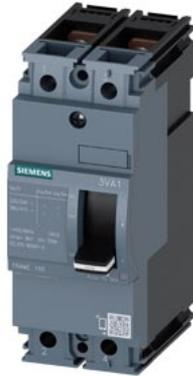
Leistungsschalter 3VA1 IEC Frame 160 Schaltvermögenklasse S Icu=36kA @ 415V 2-polig, Anlagenschutz TM210, FTFM, In=32A Überlastschutz Ir=32A fest eingestellt Kurzschlusschutz Ii=10 x In Schraubenflachanschluss
