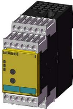
SIRIUS Sicherheitsschaltgerät sicherheitsgerichtete Stillstandsüberwachung AC 400 V, 45 mm Schraubanschluss FK unverzögert: 3 S + 1 Ö FK verzögert: 0 MK: 3 Auto-Start Grundgerät max. Fehler-Kat. EN 954-1: 4 maximal erreichbarer PL nach EN 13849-1: e maximal erreichbarer SIL nach IEC 61508: 3
