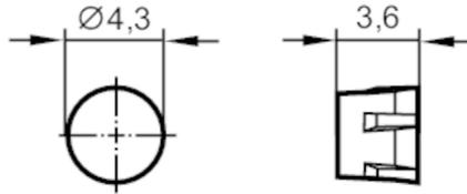
Montagebohrung  $\varnothing$  4,0 x 3,7 mm
