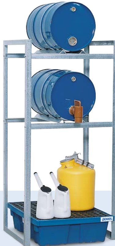
Fassregal Typ FR-K 2-60 für 2 Fässer à 60 Liter, mit Auffangwanne aus Polyethylen, Gitterrost optional
