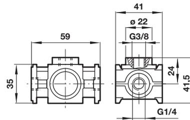
**Anschlussflansch mit Druckschalter
