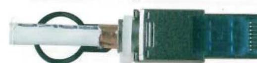
8. Mit dem Kabelbinder Steckergehäuse und Kabel fixieren.
