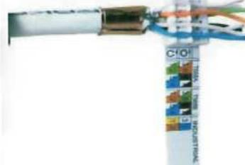
4. Die Kabeladern durch den Kabelmanager führen.
