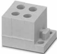
Kabeltülle, klein, Anzahl der Leitungen: 4, Ausführung: Rundkabel, geschlitzt, Leitungsaußendurchmesser: 4x 5,4 mm ... 5,7 mm, Material: SEBS (halogenfrei), Farbe: grau, Länge: 29,5 mm, Breite: 19,5 mm, Höhe: 17 mm
