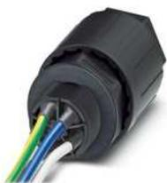
QUICKON-Wanddurchführung, 4+PE-polig, 2,5 mm<sup>2</sup>... 6,0 mm<sup>2</sup> / 690 V / 40 A, mit QUICKON-Mutter, schwarz, für Kabeldurchmesser 12 mm ... 20 mm, M25-Anschlussgewinde mit 5 angeschweißten 6,0 mm<sup>2</sup> Leitungsadern, 1,0 m lang, am Ende glatt abgeschnitten.
