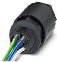
QUICKON-Wanddurchführung, 4+PE-polig, 2,5 mm<sup>2</sup>... 6,0 mm<sup>2</sup> / 690 V / 40 A, mit QUICKON-Mutter, schwarz, für Kabeldurchmesser 12 mm ... 20 mm, M25-Anschlussgewinde mit 5 angeschweißten 6,0 mm<sup>2</sup> Leitungsadern, 0,5 m lang, am Ende glatt abgeschnitten.
