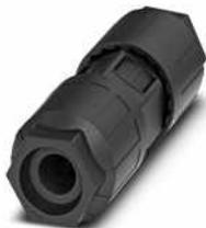
QUICKON Leitungsbinder, schwarz, 4+PE-polig, 2,5 mm<sup>2</sup> ... 6,0 mm<sup>2</sup> / 690 V / 40 A, für Kabeldurchmesser 12 mm ... 20 mm.
