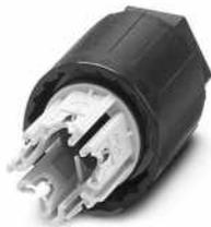
QUICKON-Mutter, schwarz, 4+PE-polig, 2,5 mm<sup>2</sup> ... 6,0 mm<sup>2</sup> / 690 V / 40 A, für Leitungen mit Durchmesser 12 mm ... 20 mm.
