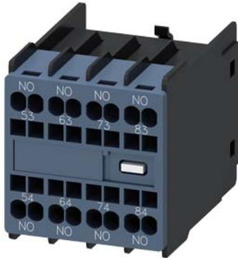
Hilfsschalter, frontseitig, 4 S, 53/54, 63/64, 73/74, 83/84, Strombahn: 1 S, 1 S, 1 S, 1 S, Federzuganschluss, für Schütze 3RT2 und Hilfsschütze 3RH2
