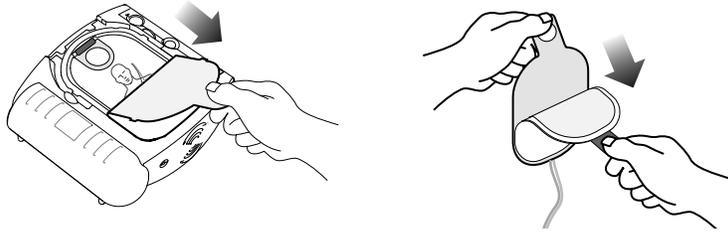
Ziehen Sie eine Elektrode von der Plastikfolie ab. Bringen Sie die Elektrode genau wie in der Abbildung auf der Elektrode gezeigt auf der bloßen Haut des Patienten an. Drücken Sie die Elektrode fest an. Wiederholen Sie dies mit der anderen Elektrode. Vergewissern Sie sich vor dem Anbringen der Elektrode, dass die Folie entfernt wurde.
