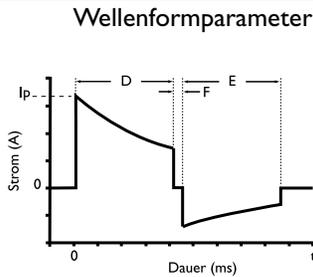
Abgeschnittene Zweiphasen-Exponentialkurve. Wellenformparameter werden als eine Funktion der Patientendefibrillationsimpedanz automatisch angepasst. In der Abbildung links ist D die Dauer der Phase 1 und E die Dauer der Phase 2 der Wellenform. F ist die Zwischenphasenverzögerung (500  $\mu$ s) und Ip die Spitzenspannung.
