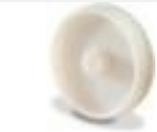
Rad, Traglast 200 kg, Mit Kunststoff-Bereifung, Durchmesser x Breite 150 x 40 mm, Nabe mit Gleitlager, Felge aus Kunststoff
