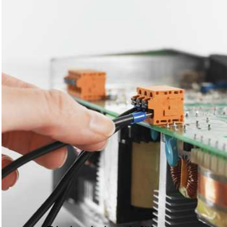
Direkte Leitereinführung Querschnitt bis 2,5 mm 2
