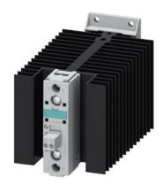
Halbleiterschütz 1-phasig 3RF2 AC 15 / 27,5 A / 40  $^{\circ}$ C 24-230 V / DC 24 V momentanschaltend Seit 21.5.2018 haben sich die Abmessungen und das Bohrbild geändert, weitere Info im Industry Online Support
