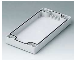
C0081602 Gehäuseschale 80, mit Dichtung PC (UL 94 HB) lichtgrau RAL 7035 160x80x20mm
