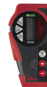
Leica RRC350 Fernbedienung/Empfänger-Kombigerät mit Klammer Art. Nr. 762 771 Zum Auffinden des roten Referenz-Laserstrahls auf einer Distanz bis zu 150 m. Reichweite der Fernbedienung: 30 m. Für Roteo 20HV, 35
