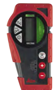
Leica RRC350G Fernbedienung/Empfänger-Kombigerät mit Klammer Art. Nr. 772 795 Zum Auffinden des grünen Referenz-Laserstrahls auf einer Distanz bis zu 150 m. Reichweite der Fernbedienung: 30 m. Für Roteo 35G
