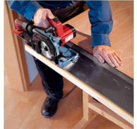
In Kombination mit der rollbaren Flexi-Schiene FX 140 sind präzise geführte Schnitte bis 1,4 m kein Problem.
