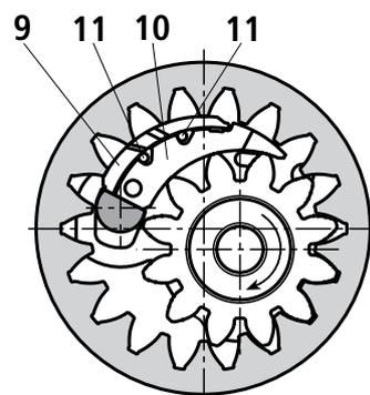
Une petite composante de la force de pression serre le segment et le support de segment contre les sommets des dents de l'arbre de pignon et de la roue à denture intérieure et assure ainsi un étanchement à réglage automatique du jeu entre la zone de pression et la zone d'aspiration.
