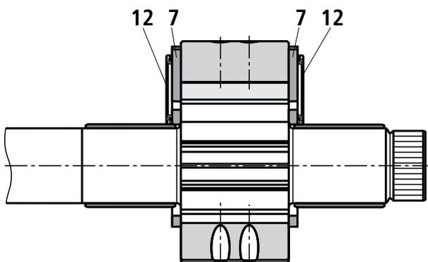
Les côtés des plaques qui ne sont pas en contact avec la chambre de refoulement, sont munis d'un champ de pression (12). Ces champs balancent les plaques par rapport à la chambre de refoulement et assurent ainsi un étanchement optimal à une perte mécanique minimale.
