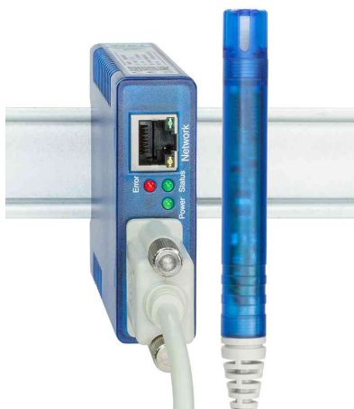
Visuel de référence: thermo-hygromètre web (livré sans rail)
