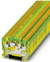
Schutzleiter-Reihenklemme, Anzahl der Anschlüsse: 4, Anschlussart: Push-in-Anschluss, 1. Etage, Querschnitt: 0,14 mm<sup>2</sup> - 4 mm<sup>2</sup>, Montageart: NS 35/7,5, NS 35/15, Farbe: grün-gelb
