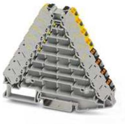
Potenzialverteiler, Nennspannung: 250 V, Nennstrom: 17,5 A, Anschlussart: Push-in-Anschluss, 1., 2., 3., 4., 5., 6., 7. und 8. Etage, Bemessungsquerschnitt: 1,5 mm<sup>2</sup>, Querschnitt: 0,14 mm<sup>2</sup> - 2,5 mm<sup>2</sup>, Montage: NS 35/7,5, NS 35/15, Farbe: grau, Farbe Anschlusselemente: gelb, schwarz
