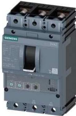
Leistungsschalter 3VA2 IEC Frame 160 Schaltvermögenklasse L Icu=150kA @ 415V 3-polig, Anlagenschutz ETU330, LIG, In=100A Überlastschutz Ir=40A...100A Kurzschlusschutz Ii=1,5...12 x In Erdschlussschutz Ig=0,2...1 x In, tg=0,1/0,3s Schraubenflächanschluss
