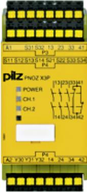
Sicherheitsschaltgerät (standalone) Eingänge: 1/2-kanalige Beschaltung, mit/ohne Querschlusserkennung, Ausgänge: 3 S, 1 Ö, 1 HL, automatischer/überwachter Start, UB = 24 V AC/DC, Breite: 45 mm, steckbare Federkraftklemmen, Überwachung von Not-Halt, Schutztüren.
