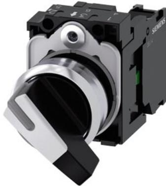
Knebelschalter, 22 mm, rund, Metall, hochglanz, weiß, Knebel, lang, 2 Schaltstellungen O-I, verrastend, Schaltwinkel 90°, 10:30h/13:30h, mit Halter, 1S, Schraubanschluss
