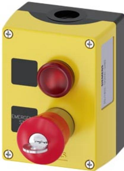
Gehäuse für Befehlsgeräte 22 mm, rund, Gehäusematerial Kunststoff, Gehäuseoberteil gelb, 2 Befehlsstellen Kunststoff, B = Leuchtmelder, rot, LED 24V AC/DC, Schraubanschluss, Schild ohne Aufschrift, A= NOT-HALT, 40 mm, RONIS SB30, Schild mit Beschriftung: EMERGENCY STOP, 1S, 1Ö, Schraubanschluss, Bodenbefestigung, oben und unten je 1xM20, Schilder beigelegt
