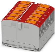
Verteilerblock, Nennspannung: 450 V, Nennstrom: 24 A, Anzahl der Anschlüsse: 12, Polzahl: 1, Anschlussart: Push-in-Anschluss, Bemessungsquerschnitt: 2,5 mm<sup>2</sup>, Querschnitt: 0,14 mm<sup>2</sup> - 4 mm<sup>2</sup>, Montageart: aufrasten auf Tragschienenadapter, Direktmontage mit Flansch, Liegend, Farbe: rot
