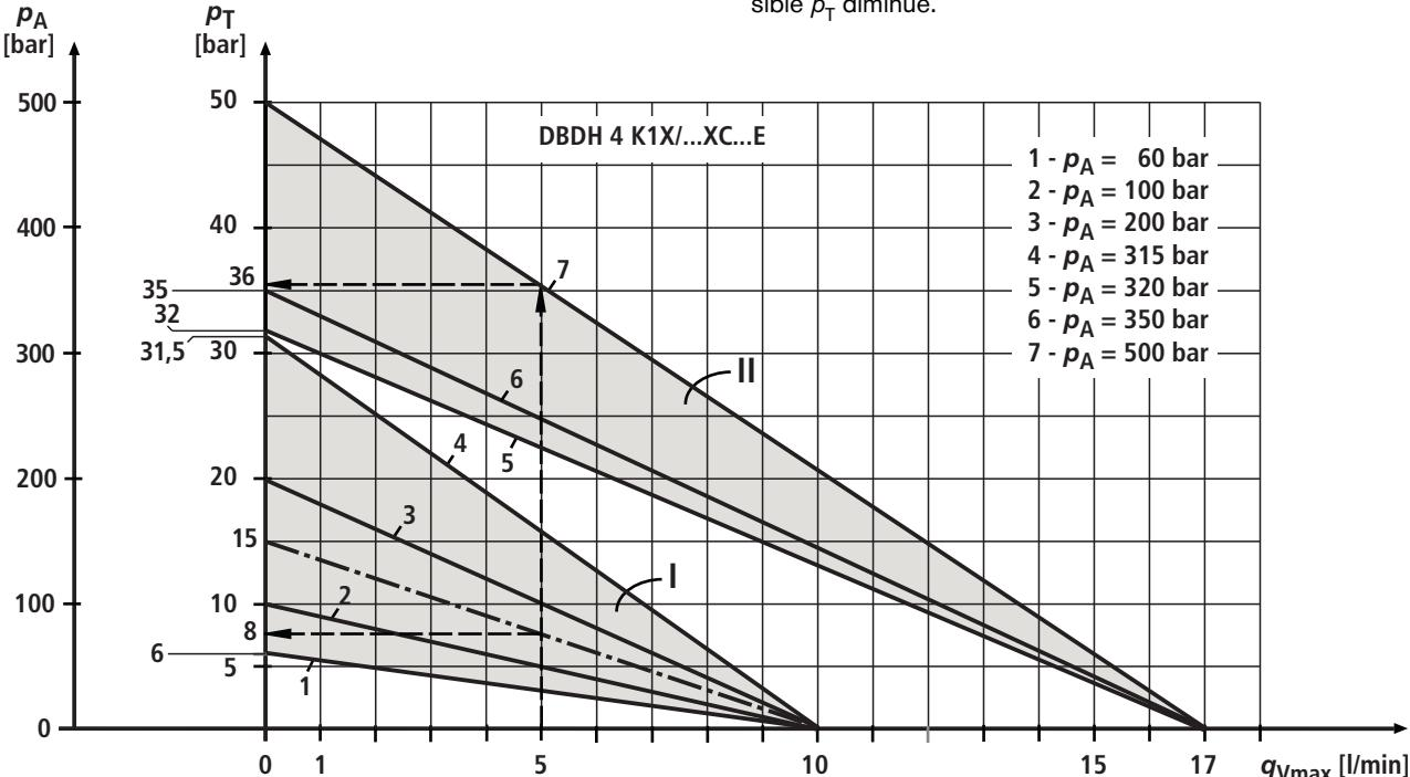
Diagramme servant à déterminer la contre-pression maximale admissible  $p_T$  dans la conduite de retour au raccord T de la valve en fonction du débit  $q_{Vmax}$  pour les valves DBDH 4K1X/...XC...E avec différentes pressions de fonctionnement  $p_A$ .
