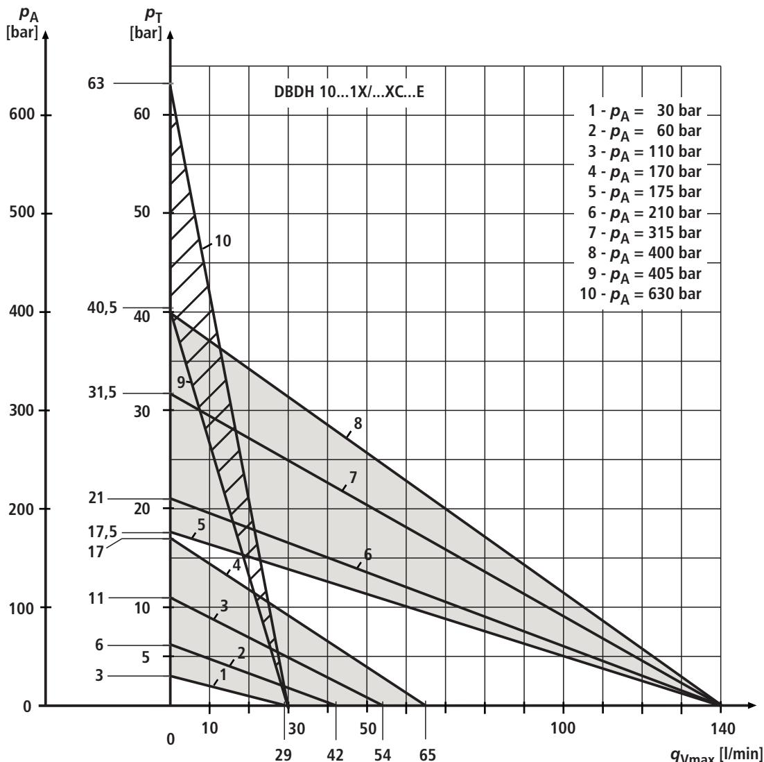
Diagramme servant à déterminer la contre-pression maximale admissible  $p_T$  dans la conduite de retour au raccord T de la valve en fonction du débit  $q_{V\max}$  pour les valves DBDH 10...1X/...XC...E avec différentes pressions de fonctionnement  $p_A$ .
