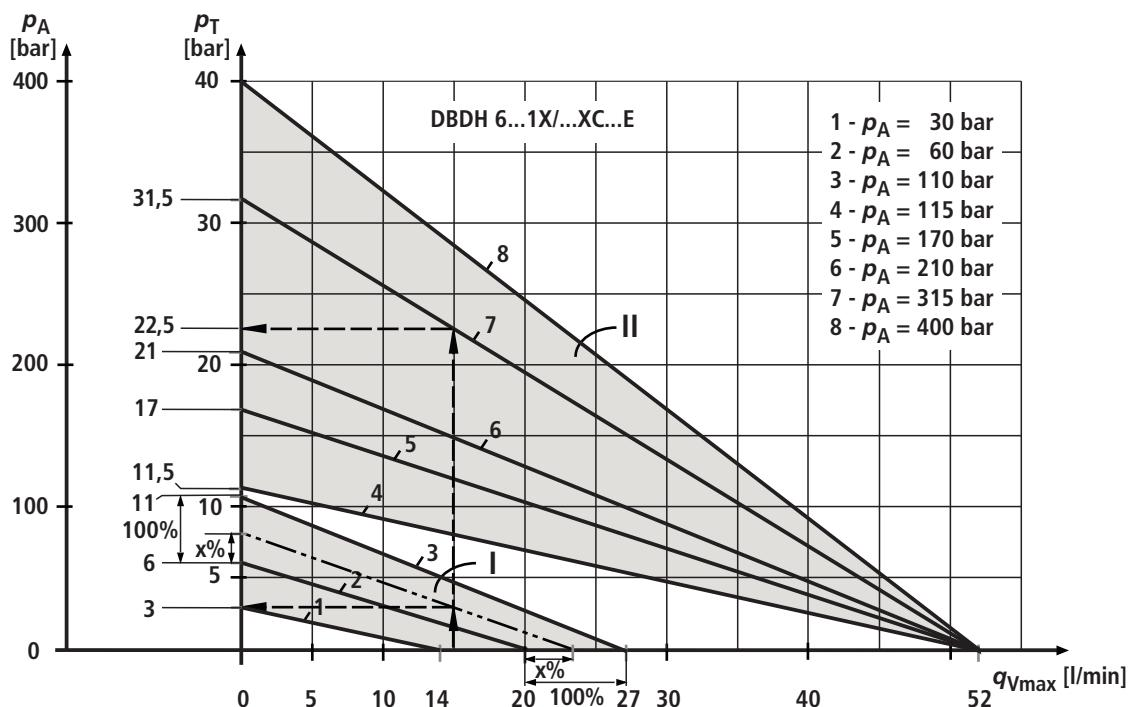
Diagramme servant à déterminer la contre-pression maximale admissible  $p_T$  dans la conduite de retour au raccord T de la valve en fonction du débit  $q_{V\max}$  pour les valves DBDH 6...1X/...XC...E avec différentes pressions de fonctionnement  $p_A$ .
