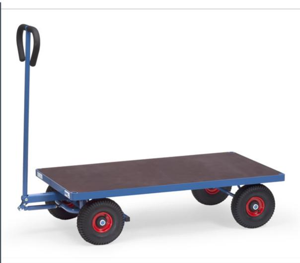
Aus Profilstahl und Stahlrohr geschweißt, pulverbeschichtet blau RAL 5007. Ladefläche aus wasserfestem Sperrholz. Drehschemel-Lenkung mit Deichsel und Handgriff. Wahlweise Räder mit Vollgummi- oder Luftbereifung, Naben mit Rollenlager. Deichsel mit Sicherheitshandgriff mit Softgripbezug und automatischer gedämpfter Rückstellung in Ruheposition. Automatische Feststellbremse auf die Vorderräder wirkend, entspricht der Europäischen Norm EN 1757-3.
