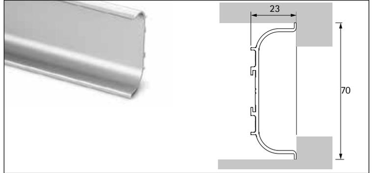
**de** Beim horizontalen Einsatz des Profils hinter Drehtüren muss ein Scharnier mit einem Öffnungswinkel von max. 90° oder ein Öffnungswinkelbegrenzer, eingestellt auf max. 90°, verwendet werden, um mögliche Beschädigungen an der Türkante zu vermeiden. Alternativ kann mit Hilfe der Tiefenverstellung am Scharnier die Fuge zwischen der Korpuskante und der Tür vergrößert werden.
