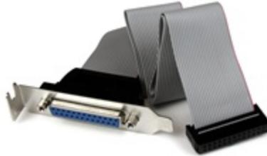
Le support de port parallèle PLATE25F16LP DB25 vers IDC26 ajoute un port parallèle DB25 au panneau arrière d'un ordinateur à faible encombrement ou de format compact, en se branchant à un connecteur IDC26 de la carte mère.
