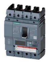
Leistungsschalter 3VA6 UL Frame 150 Schaltvermögenklasse H 65kA @ 480V 4-polig, Anlagenschutz ETU830, LIG, In=40A Überlastschutz Ir=16A...40A Kurzschlussschutz Ii=1,5...12 x In Erdschlussschutz Ig=0,375...1 x In, tg=0,05-0,8s ohne Anschluss
