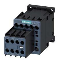
Leistungsschütz, AC-3 9 A, 4 kW / 400 V 2 S + 2 Ö , DC 24 V 3-polig, Baugröße S00 Schraubanschluss Hilfsschalter lösbar
