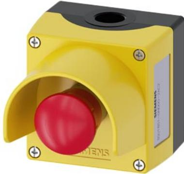
Gehäuse für Befehlsgeräte, 22 mm, rund, Gehäusematerial Metall, Gehäuseoberteil gelb, mit Schutzkragen, 1 Befehlsstelle Metall, A=NOT-HALT-Pilzdrucktaster rot, 40 mm, drehentriegelt, 1S, 1Ö, 1Ö, Schraubanschluss, Bodenbefestigung, oben und unten je 1xM20
