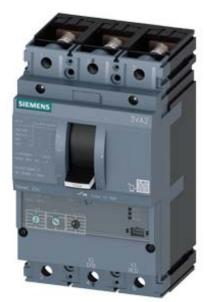
LEISTUNGSSCHALTER 3VA2 IEC FRAME 250 SCHALTVERMOEGENKLASSE C ICU=110KA @ 415 V 3-POLIG, MOTORSCHUTZ ETU350M, LSI, IN=200A UEBERLASTSCHUTZ IR=80A ...200A KURZSCHLUSSSCHUTZ ISD=3... 15 X IR, II=15 X IN SCHRAUBENFLACHANSCHLUSS
