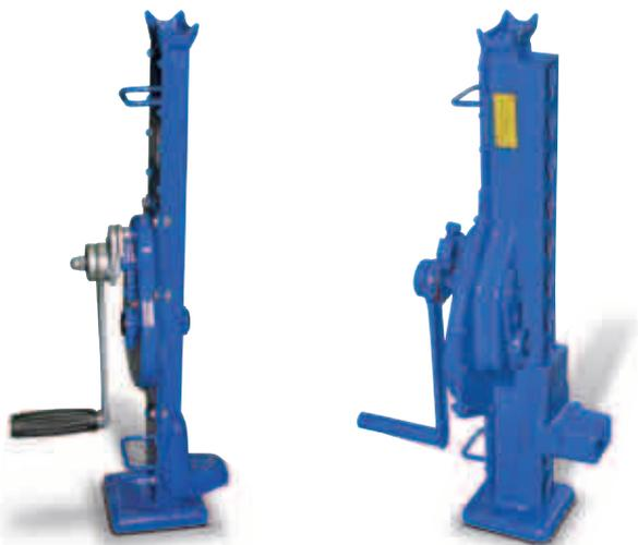
**Manivelle de sécurité à double cliquet de blocage.** En tournant la manivelle vers la droite, la charge monte et vers la gauche, elle descend. Blocage automatique, la charge est maintenue en toute position.
