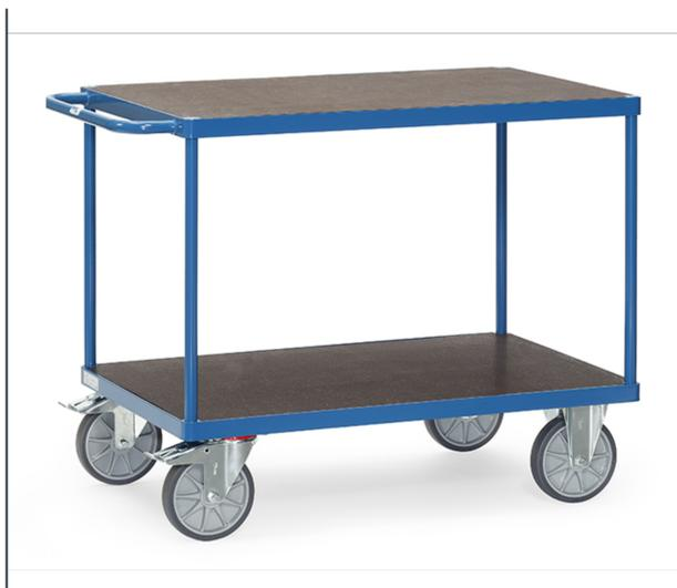
Système modulaire. Ensemble mécano-soudé, revêtement époxy bleu RAL 5007. Dimensions utiles 1200 x 800 mm. Avec 2 plateaux en contreplaqué antidérapant hydrofuge. Charge plateau du haut, maxi 200 kg. 2 roues pivotantes et 2 roues fixes à bandage TPE, moyeu à roulement à billes central. Freins sur roues pivotantes conformément à la Norme 1757-3 (Sécurité des chariots de manutention).
