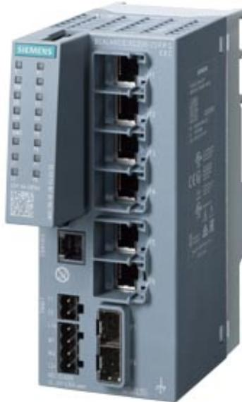
SCALANCE XC206-2SFP G EEC managebarer Layer 2 IE Switch; IEC 62443-4-2 zertifiziert; 6x 10/100/1000 Mbit/s RJ45-Ports; 2x 1000 Mbit/s SFP; 1xKonsolen-Port; Diagnose-LED; redundante Spannungsversorgung; mit lackierten Leiterplatten; NAMUR NE21 konform; Temp.-Bereich-40°C bis +70°C; Montage: Hut-/S7-Profilschiene/Wand; Redundanzfunktionen; Office Features (RSTP, VLAN, ...); PROFINET IO-Device; Ethernet/IP-konform; C-PLUG Schacht;
