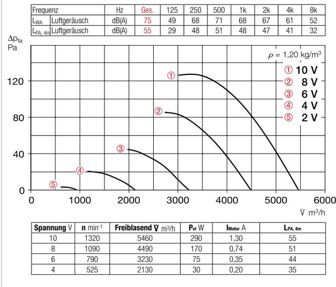
**Kennlinien HQ EC / HW EC / HRF EC 450 B**
