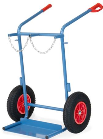
Tube d'acier soudé, revêtement époxy bleu RAL 5007. Diabale porte-bouteilles avec chaîne de maintien. Pour 2 bouteilles de 40 à 50 litres, Ø 204-229 mm. Carquois porte-baguettes de soudage de chaque côté. Roues gonflables, moyeu à roulement à rouleaux.
