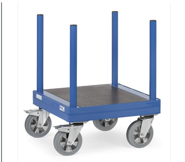
Profilstahl-Konstruktion mit einsteckbaren Stahlrohr-Rungen, pulverbeschichtet, blau RAL 5007. Wasserfeste Holzplattform. Berädern: 4 Schwerlast-Lenkrollen. Räder: Elastic-Vollgummi blaugrau "spurlos", Naben mit Kugellager. 2 Lenkrollen mit Feststeller gemäß der Europäischen Norm EN 1757-3 (Sicherheit von Plattformwagen). Lichte Breite zwischen den Rungen 510 mm.
