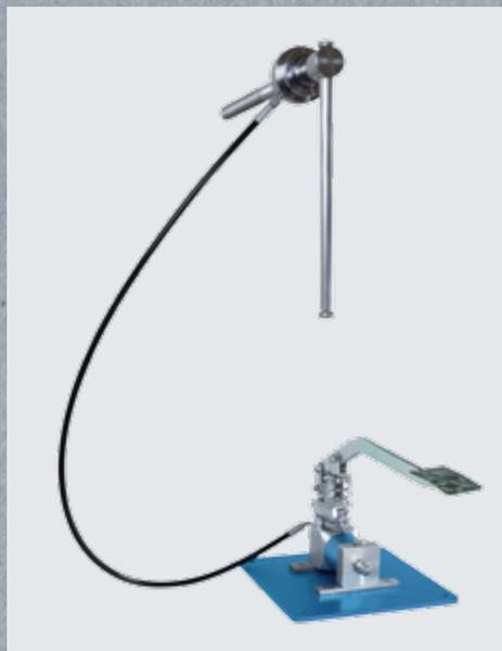
Die Funktionsweise ist denkbar einfach wie genial: Das HEUER Kurzhub-Modul nutzt den Federweg der Druckfeder in der Präzisionsspindellagerung. Dieser beträgt ca. 5 mm. Das „Spiel“ nutzt das am Spindelkopf befindliche Hydraulik-Modul, um die Vorderbacke ohne Drehen der Spindel in Richtung Hinterbacke zu drücken.
