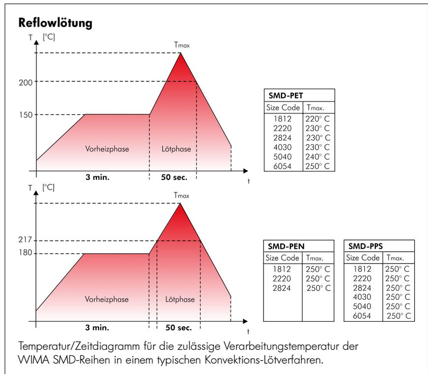
Bei Reflowlötprozessen können aufgrund der vielfältigen Verfahren keine exakten Prozessparameter spezifiziert werden. Das dargestellte Diagramm versteht sich als Empfehlung zur Ausarbeitung eines geeigneten praxisorientierten Lötprofils.
